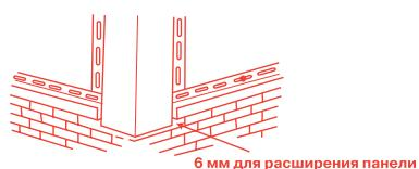
Все углы следует отрезать так, чтобы они выглядели одинаковыми, так же должен быть запас на расширение панелей от 6 до 12,5 мм под первым рядом сайдинга.
