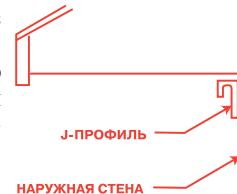
■ Сначала установите J-профили по всему периметру фронтона, соединяя внахлест. Если горизонтальный сайдинг установлен ниже вертикального, см. предыдущие страницы.
