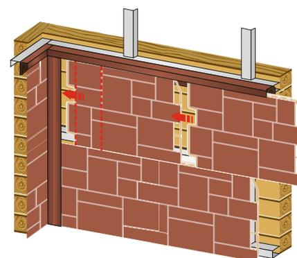
**3.3** После завершения первого ряда монтажа переходите к следующему ряду панелей. Монтаж производите аналогичным образом.
