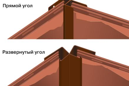
Используйте два J-профиля для обрамления внутреннего угла. Установите саморез в верхней части гвоздевого отверстия. Остальные саморезы устанавливайте по центру гвоздевых отверстий. Шаг монтажа выдерживайте 150-200 мм. Вставьте фасадную панель в J-профиль.
