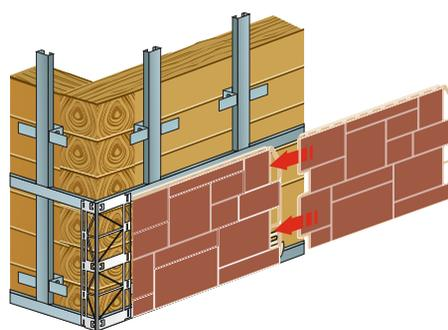
**3.2** Вторую панель заведите в стартовую планку и вплотную приблизьте ее к первой закрепленной панели, чтобы получить естественный рисунок.
